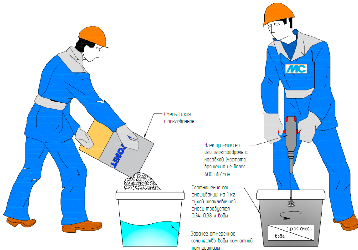
Рис. 29. Организация работ по затворению сухой шпаклевочной смеси
